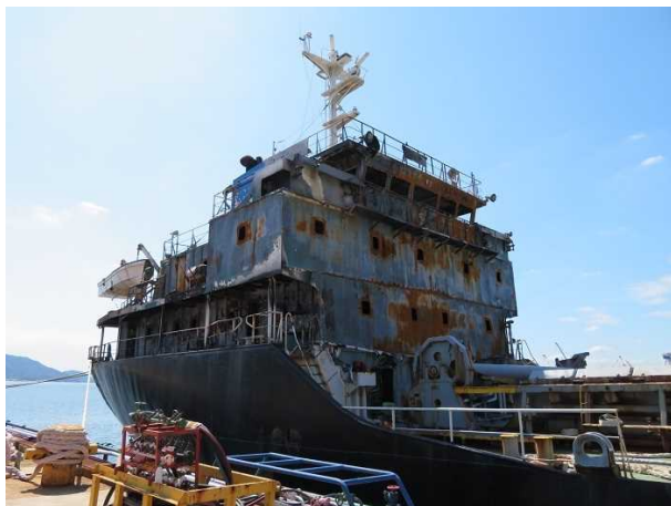
写真1 焼損状況 (上部構造物全景)
