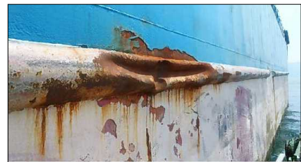
写真2 A船の右舷中央部外板の凹損
