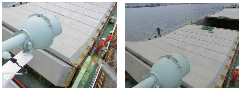
図4 ハッチカバー巻き取り中の様子
