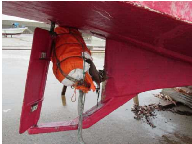
写真2 プロペラに巻き込まれた浮き樽等の状況
