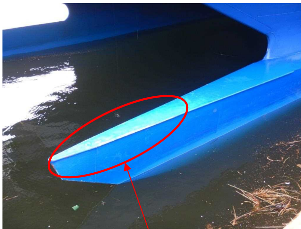
左舷ダブルステップバウの擦過傷
