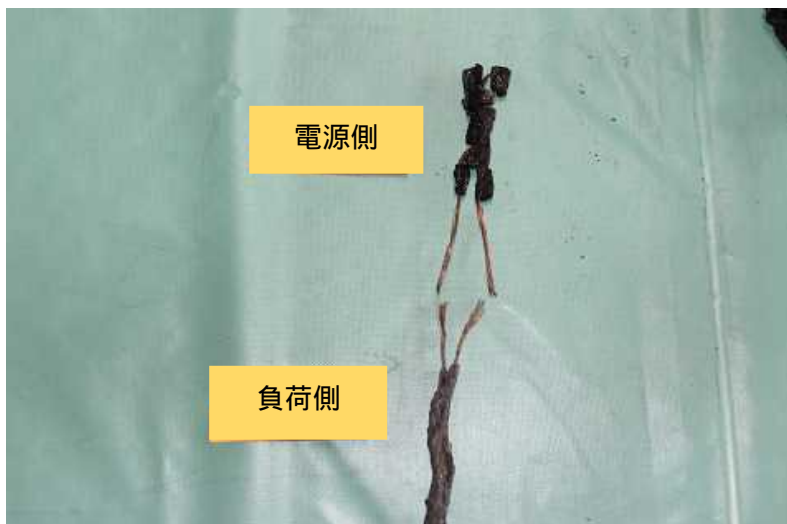
写真5 本件テーブルタップの断線部
