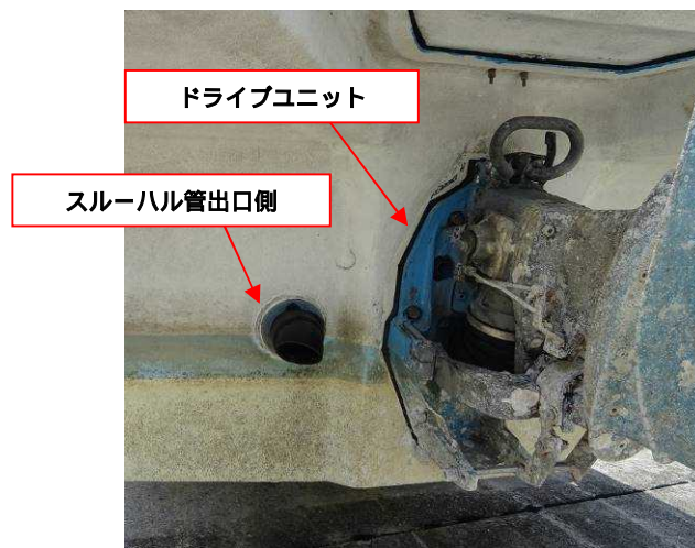
写真2 スルーハル管出口側
