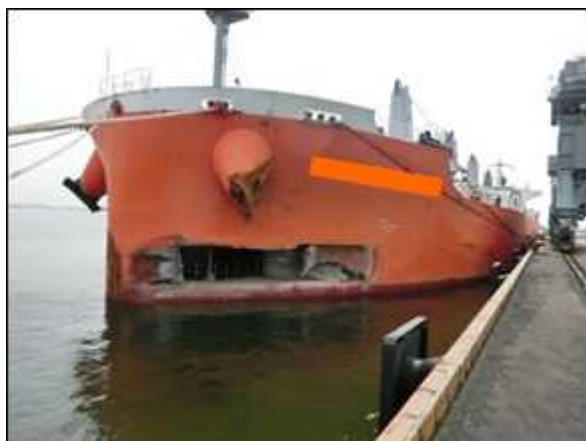
写真1 本船の損傷状況
