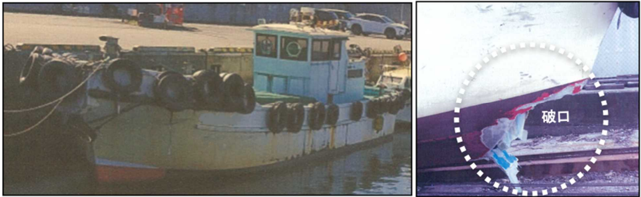
写真1 本船及び損傷状況
