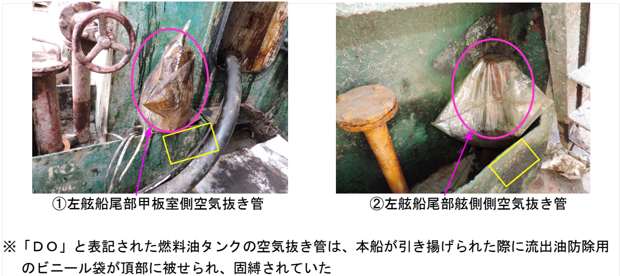
図8-2 燃料油タンク空気抜き管
