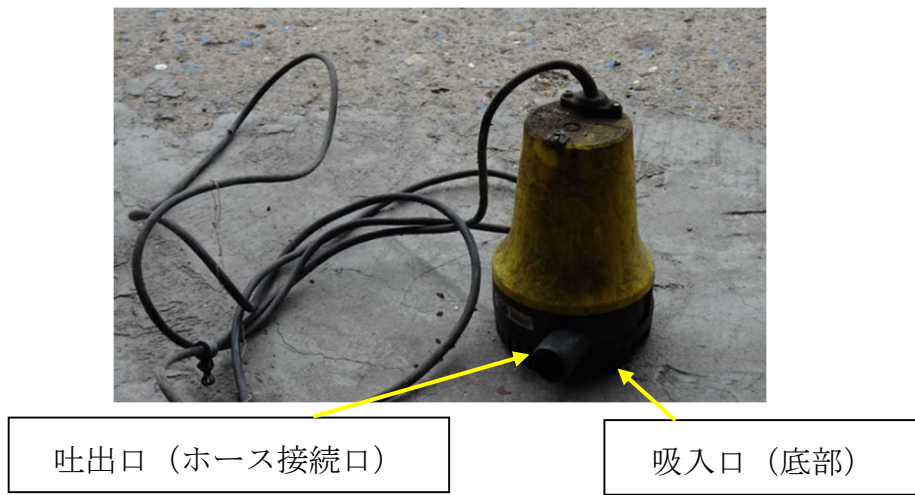
図8 本件ビルジポンプ
