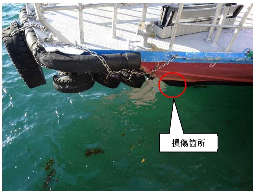
写真2 A船の損傷状況
