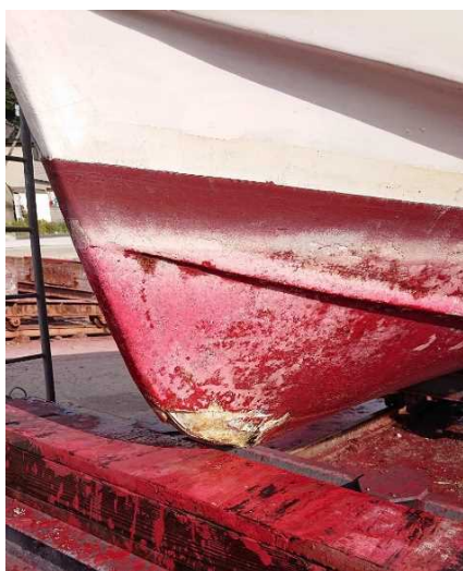
写真3 船首部船底外板の擦過傷
