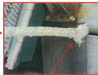
切断した錨索端
