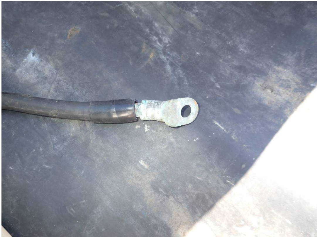
写真4 緑青の付着した丸形端子 (同型の丸型端子)
