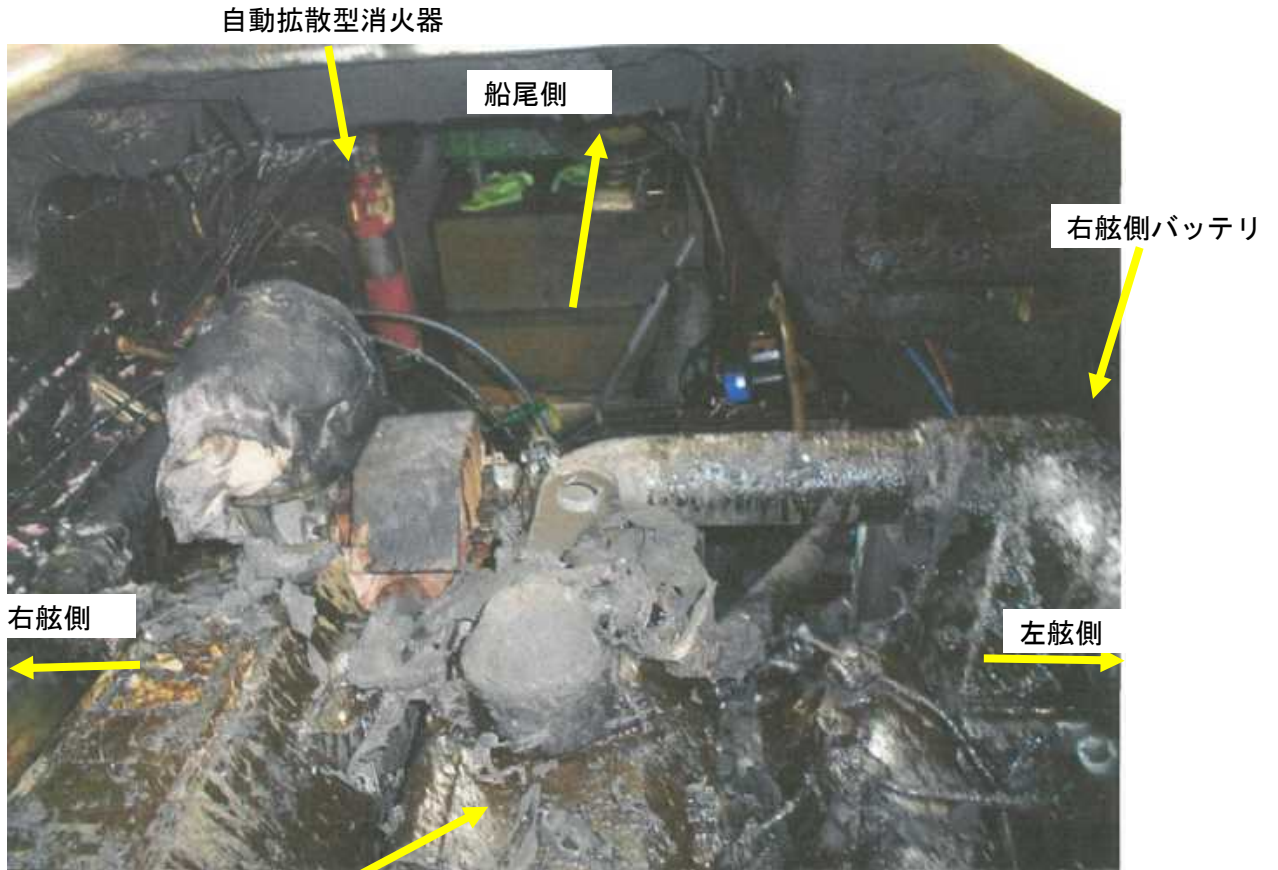
写真3 機関室焼損状況
