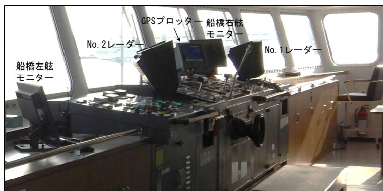
写真1 本船船橋の主なモニター画面及び航海計器の配置
