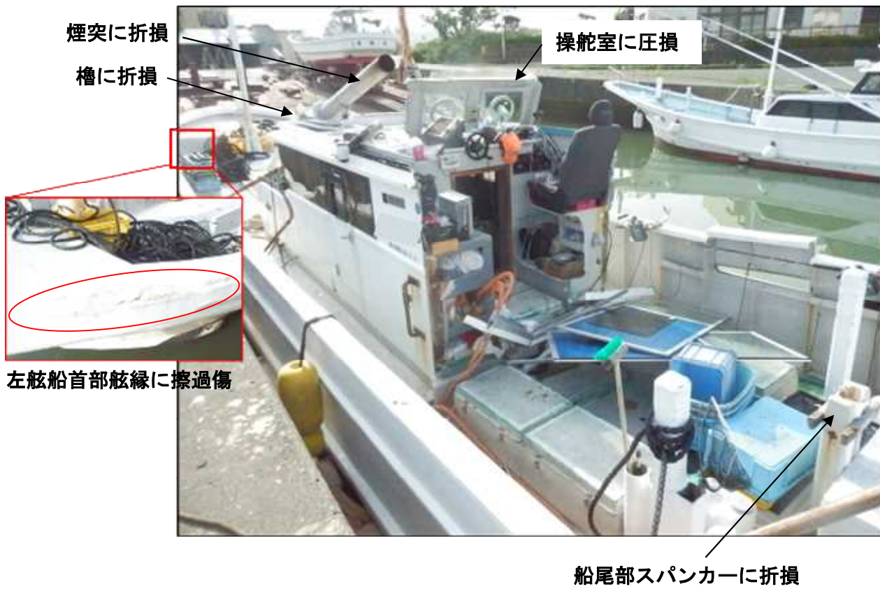
写真2 B船の損傷状況
