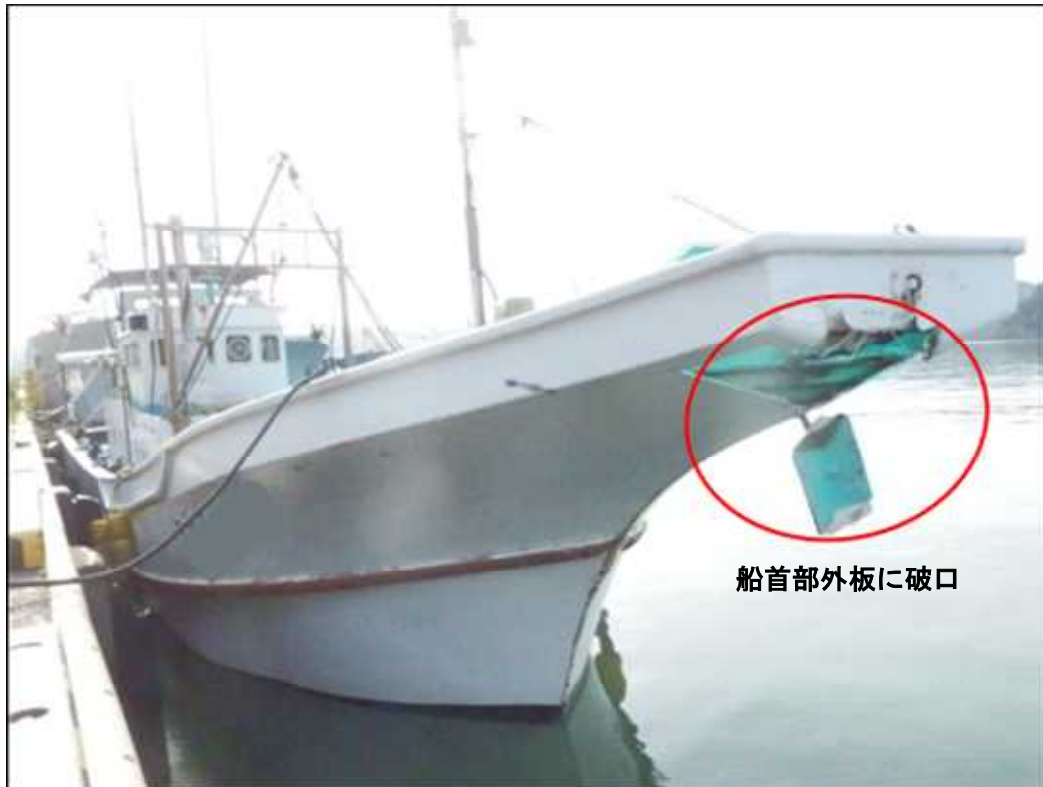
写真1 A船の損傷状況
