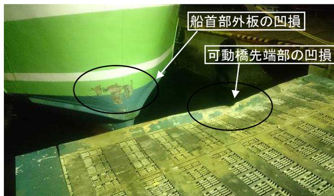
写真5 可動橋の損傷状況
