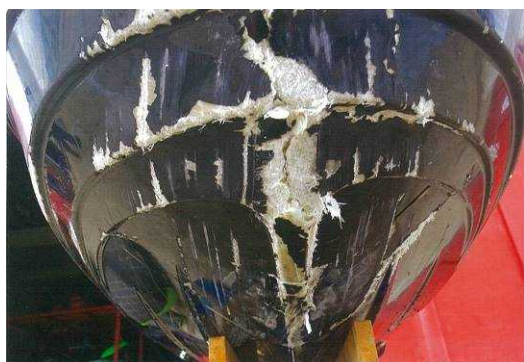
写真2 本船の損傷状況（船首部）
