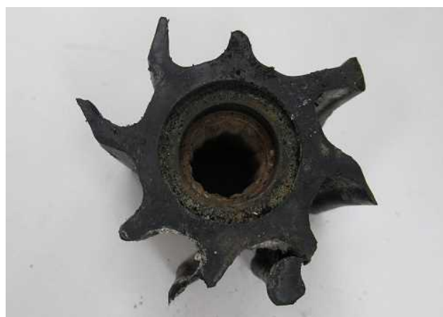
写真6 機付冷却海水ポンプのインペラの状態
