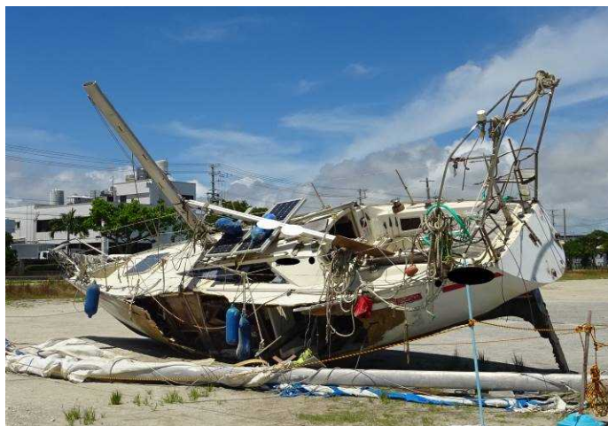
写真2 左舷中央部船底外板の損傷状況
