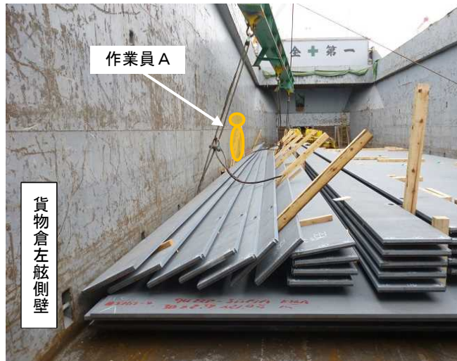
写真1 崩れた本件吊荷の状況
