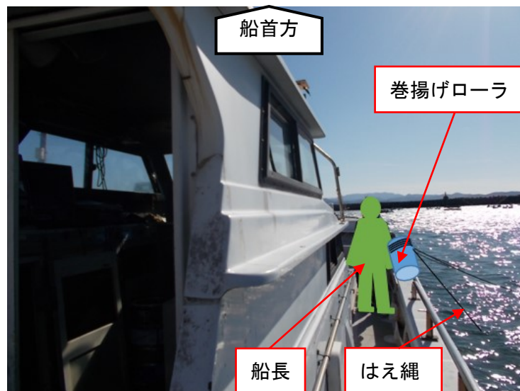
図1 巻揚げ作業の状況
