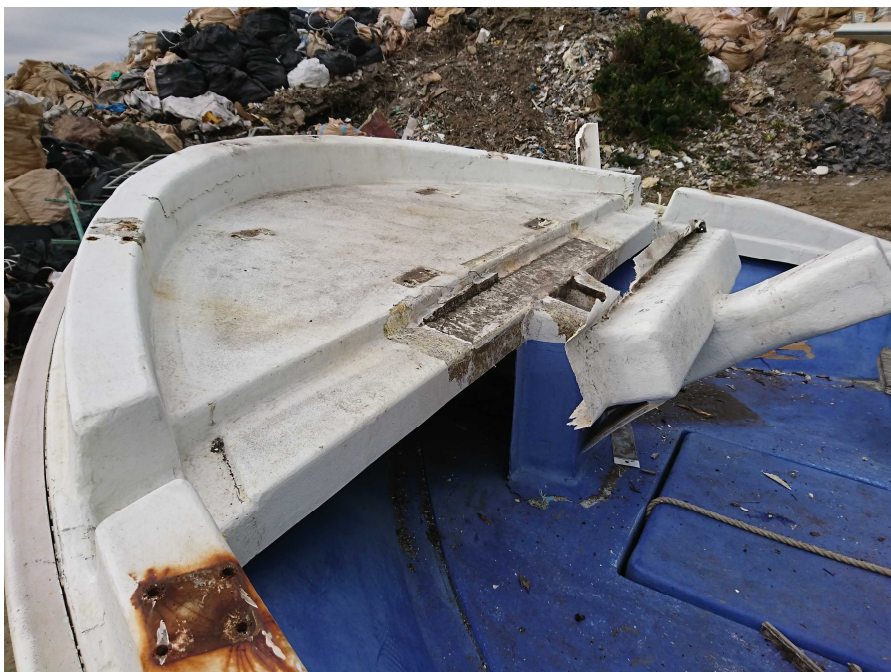
写真2 船首部損傷状況
