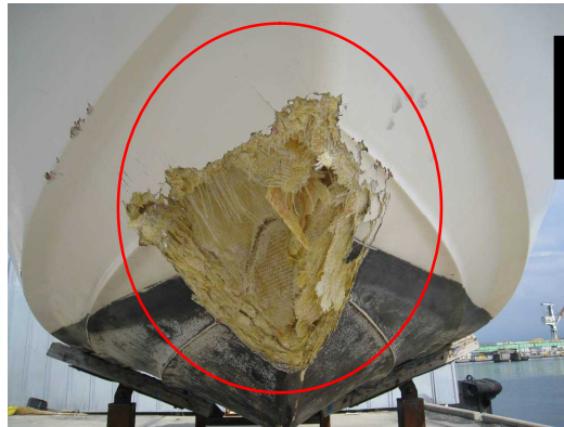
写真2 本船の船首船底部の損傷状況
