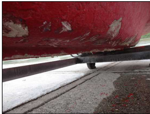
写真3 船底外板に擦過傷
