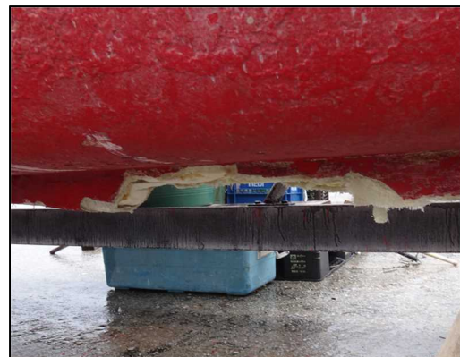
写真2 船底キールに破損
