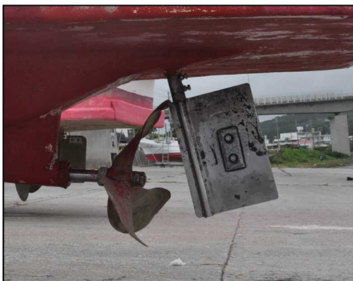
写真1 プロペラ翼及び舵軸に曲損
