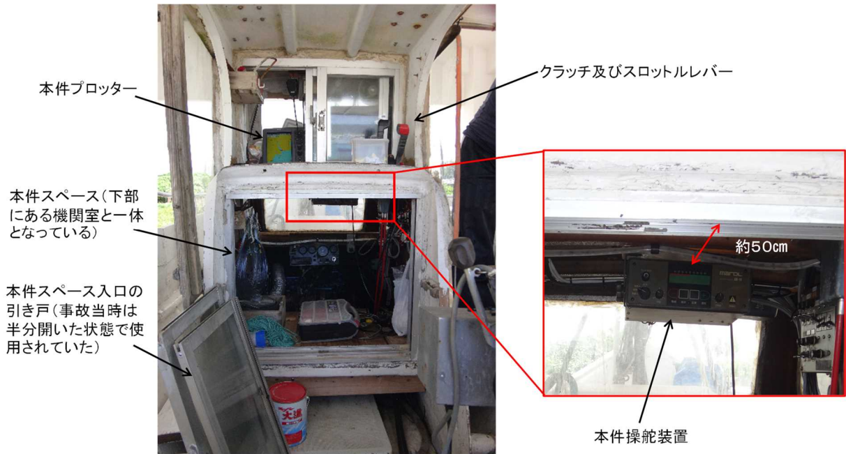
写真5 操縦区画と本件操舵装置の設置場所
