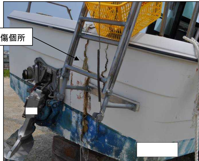
写真5 B船船尾外板に亀裂
