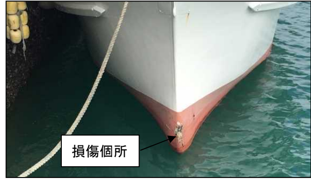
写真2 A船バルバスバウ擦過傷
