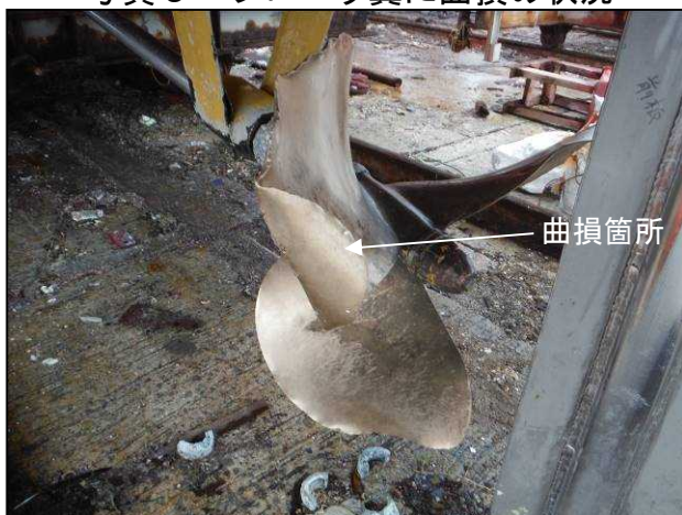
写真5 プロペラ翼に曲損の状況
