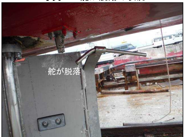
写真6 舵が脱落の状況
