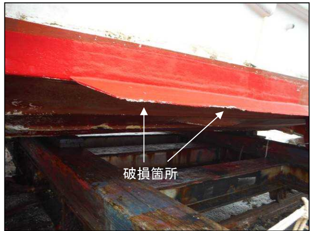
写真4 ビルジキールに破損の状況
