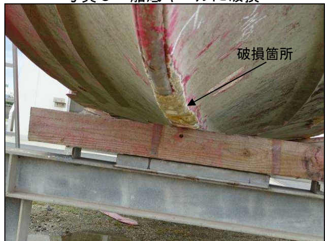
写真5 船底キールに破損
