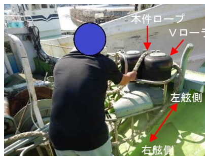
写真3 甲板員AのVローラの操作姿勢（再現）（右舷方から撮影）
