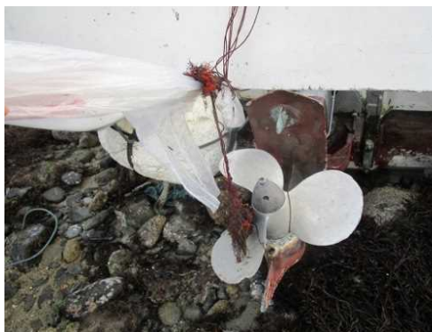
写真2 本船のプロペラに絡まった網の状況
