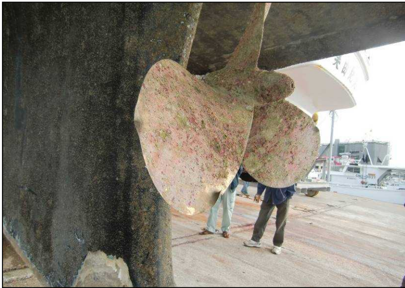
写真1 プロペラ翼曲損
