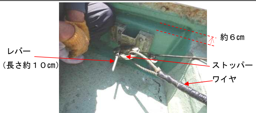
写真4 左舷側固定金具に環ワイヤが繋がった状態（再現） （ブルワーク側の約6cmの厚みは本事故後に補強したもの）
