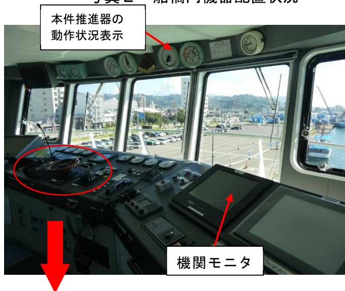
写真2 船橋内機器配置状況
