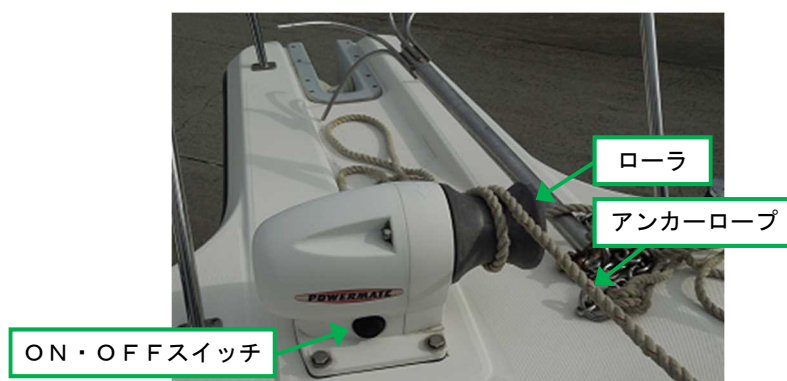
写真2 アンカーウインチ
