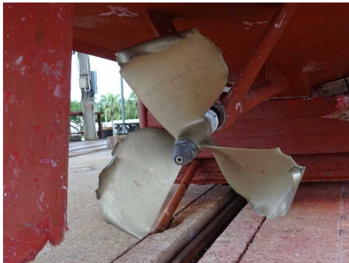
写真4 本船のプロペラの状況
