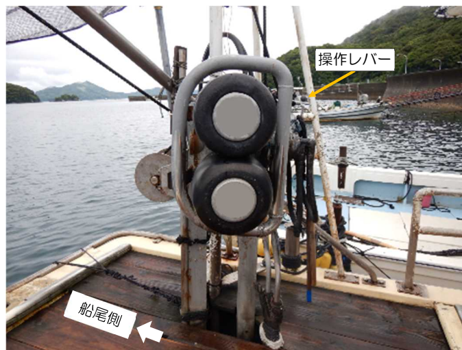
写真4 本件Vローラ（右舷方から撮影）
