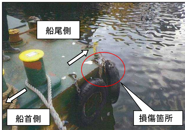
写真2 A船の損傷状況（左舷船尾部）
