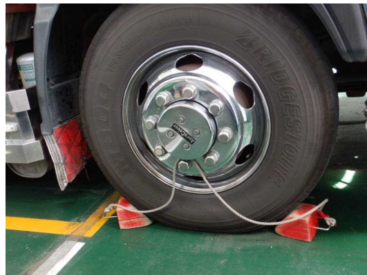
写真2 輪止め設置状況
