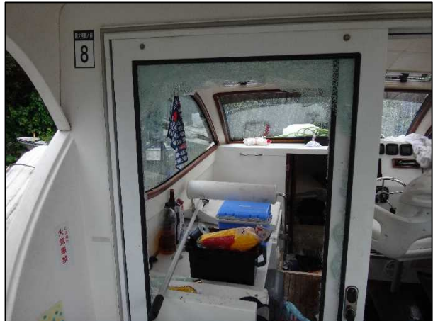
写真2.3-4 船内の扉の損傷
