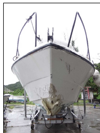
写真3.1-1 本船船首部中央損傷状況
