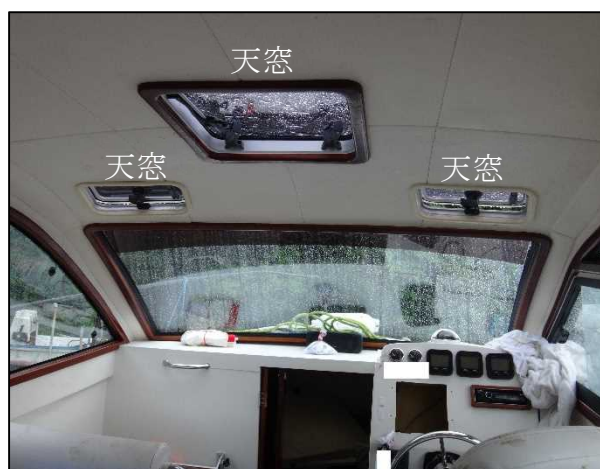
2.6-2 操縦室の天窗
