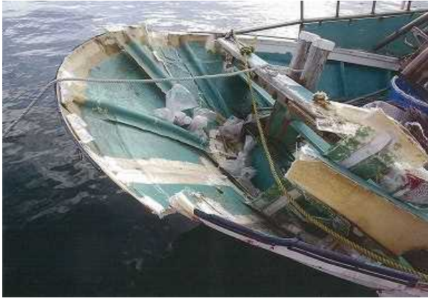
写真3 B船の船首部の損傷状況
