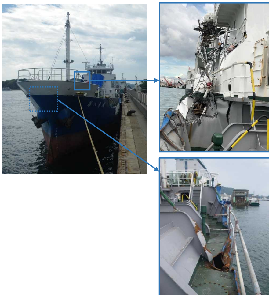
写真2 B船の損傷状況
