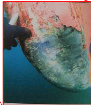
船首部船底に凹損
