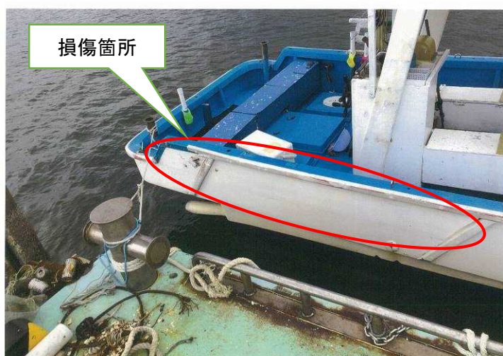
写真3 A船の損傷状況（右舷船尾側）
