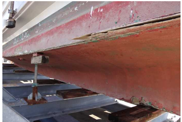
写真2 左舷船尾部船底外板の損傷状況
