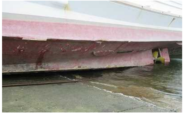
写真2 船底部の損傷状況
