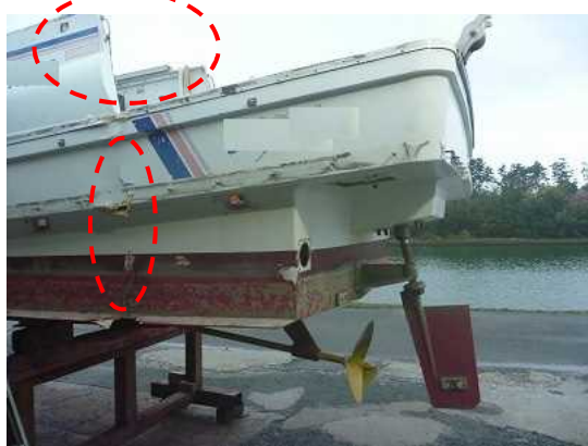
写真5 B船の左舷の損傷状況
