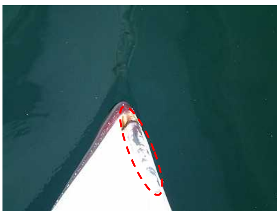
写真3 A船の船首部の損傷状況
