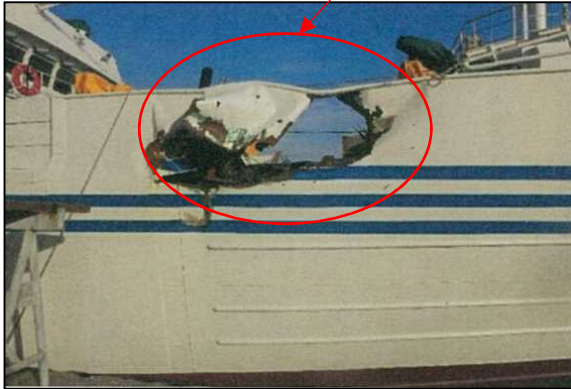
写真2 A船の損傷状況 (右舷船橋付近外板)
