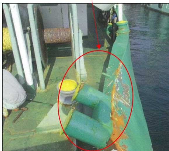
写真5 B船の損傷状況 (右舷船尾部外板)
