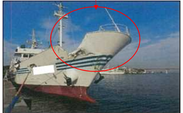
写真3 A船の損傷状況 (右舷船首部外板及び船首旗ざお)
