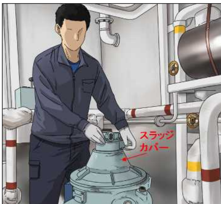
図1 スラッジカバーの取り外しを行っている機関長（イメージ）
