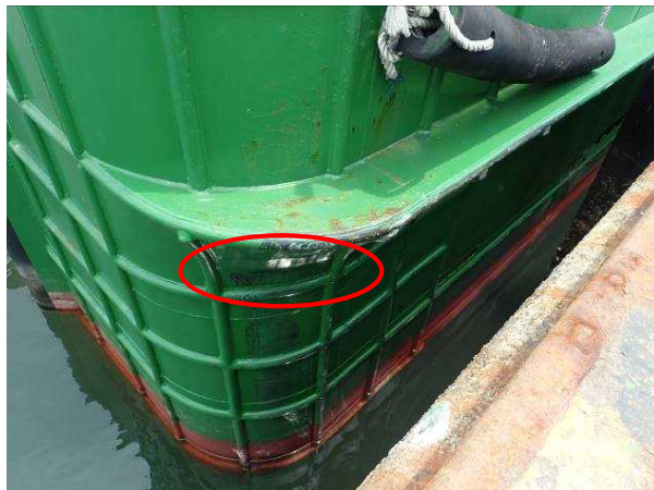
写真2 A船の損傷状況（修理後）
